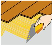
**Le collage en plein :** consiste à encoller la surface à l'aide d'une spatule crantée et à poser ensuite au contact les lames de parquets. L'encollage doit se faire par bande longitudinale dont la largeur n'exécède pas 30 cm, tenant compte des dimensions des lames et du temps ouvert (laps de temps avant la prise).
