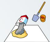
2. Mélanger le sable et le ciment en ramenant la matière sur l'autre moitié de la plaque. Répéter l'opération jusqu'à ce que le mélange soit de teinte uniforme.
